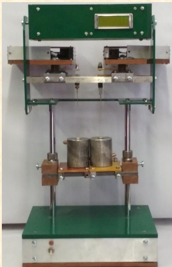
Рис. – Схема и фотография макета вискозиметра двойного резонанса: 1 – штатив, 2 – термостатированный блок образца, 3 – вибродатчики и блок управления, 4 – измерительные ячейки, 5 – блок сбора информации
