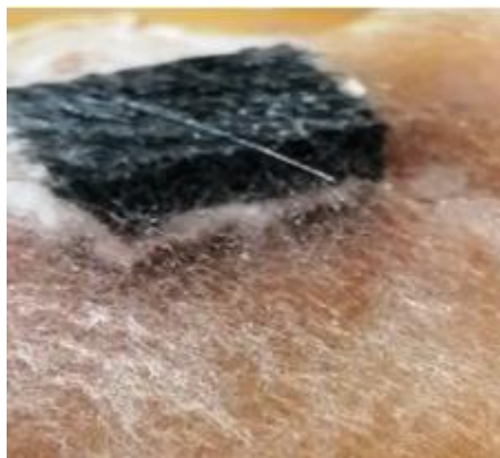
Обрастание базальтотекстолита плесневыми грибами Rhizopus sp., 04.09.2020 г.
