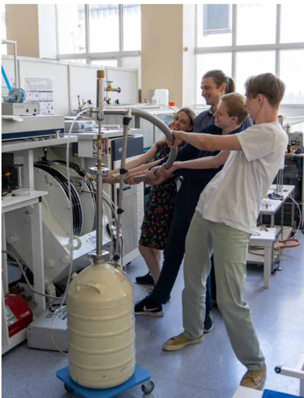
**Рис. 5.** Молодые сотрудники лаборатории упражняются в установке системы контроля температуры датчика ЭПР спектрометра.
