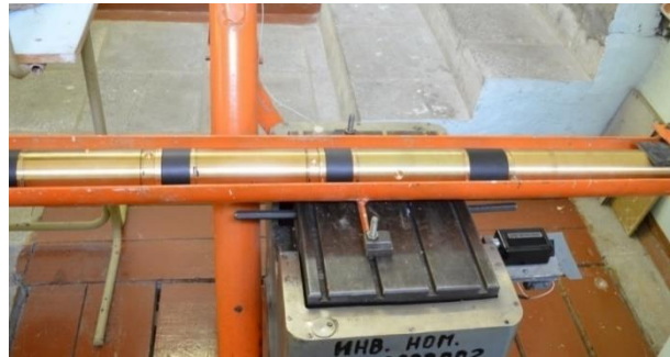
Испытания на удар в поперечной плоскости
