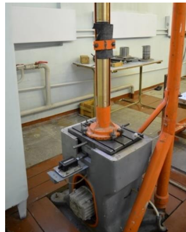
Испытания на удар по оси прибора
