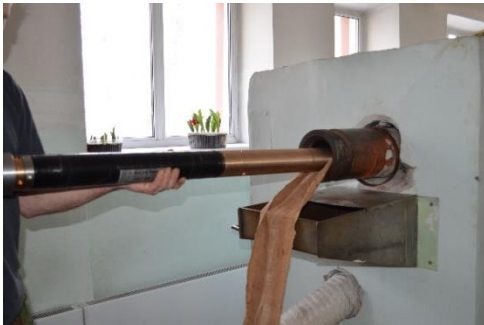
Испытания в камере высокого давления и температуры
